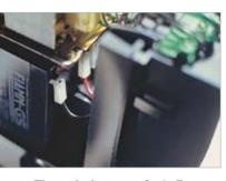
El verdadero confort. En caso de fallo en el suminstro eléctrico, la electrónica de los modelos de 24V activa inmediatamente el funcionamiento de emergencia mediante las baterías incorporadas (opcionales).
